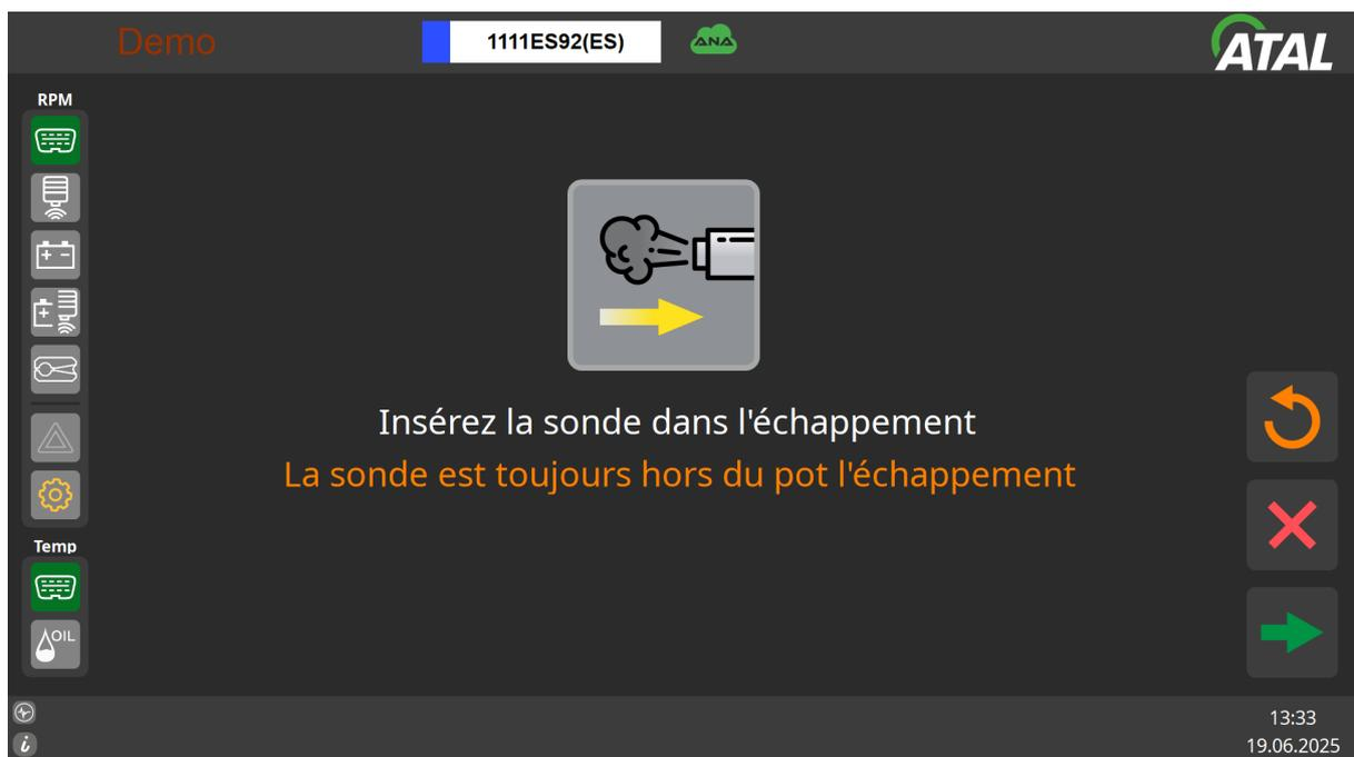
L'instrument peut détecter une sonde dans les gaz d'échappement.
