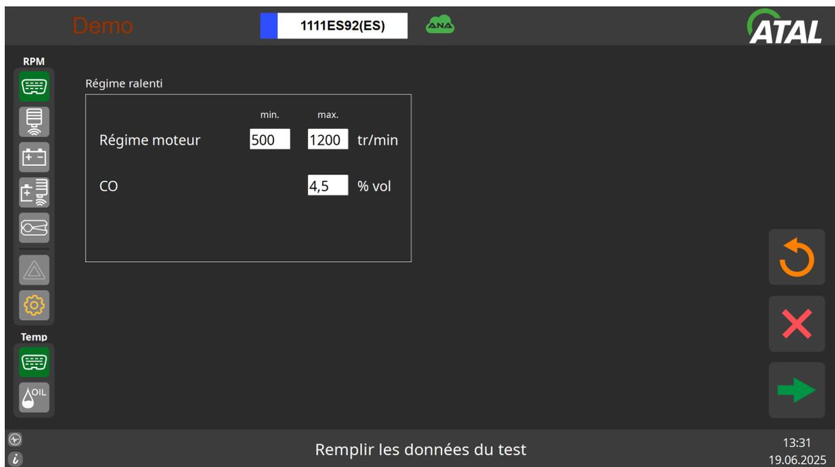
Possibilité de fixer des limites inférieure et supérieure de vitesse et de dioxyde de carbone.
