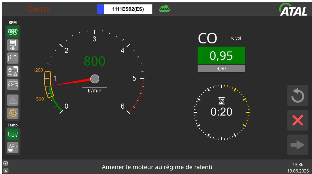
Progression du test. Dans le cas de la méthode sans régime, le tachymètre est inactif. Le test au ralenti est effectué pendant 30 secondes.
