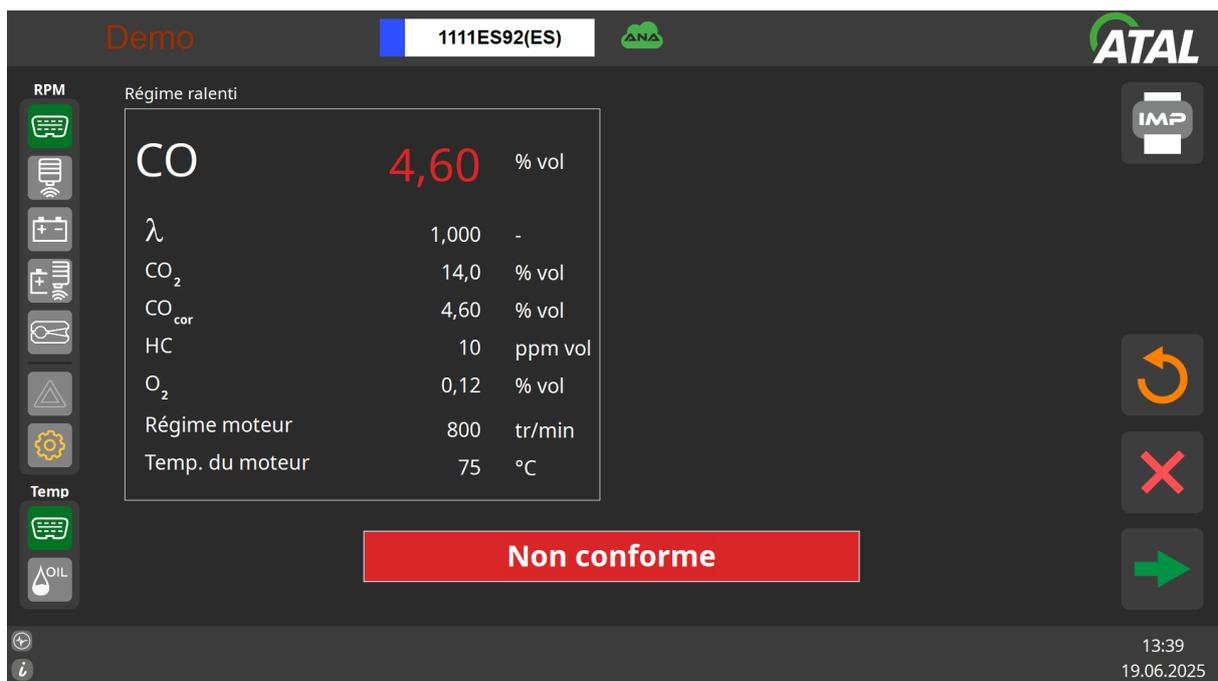
Résultats du test avec un résultat négatif. La limite de 4,5 % de CO a été dépassée.
